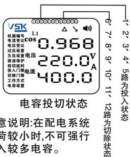
警告:(1)静态手动投切时每个回路间隔必须在1分钟以上,以防止电容器未及时放电而过电压损坏;
