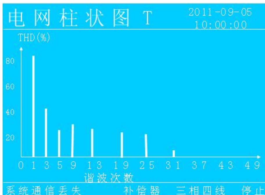
图 5.1.1.5 电网 T 相谐波柱状图
