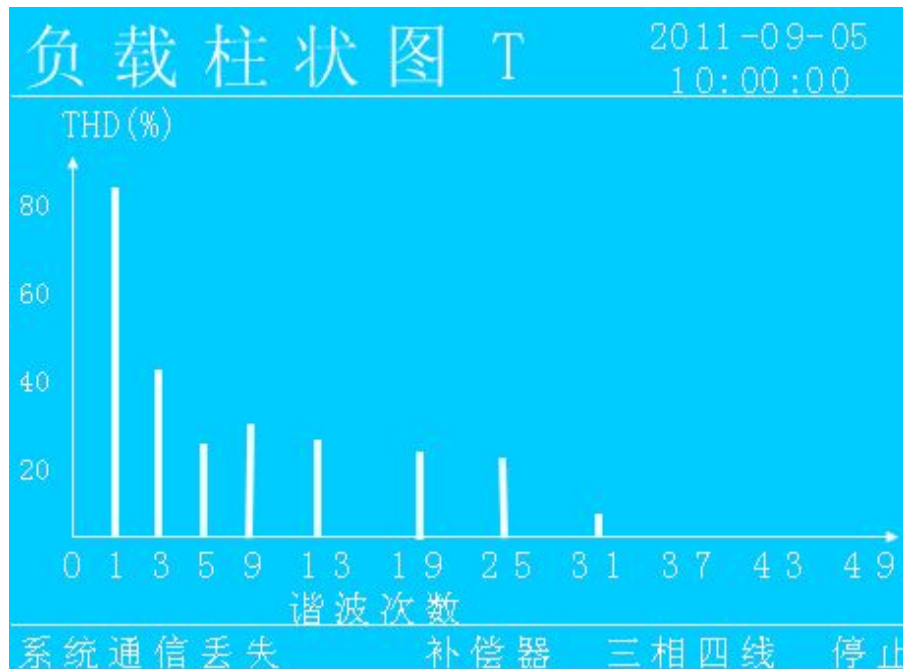
图 5.1.2.5 负载 T 相谐波状态图
