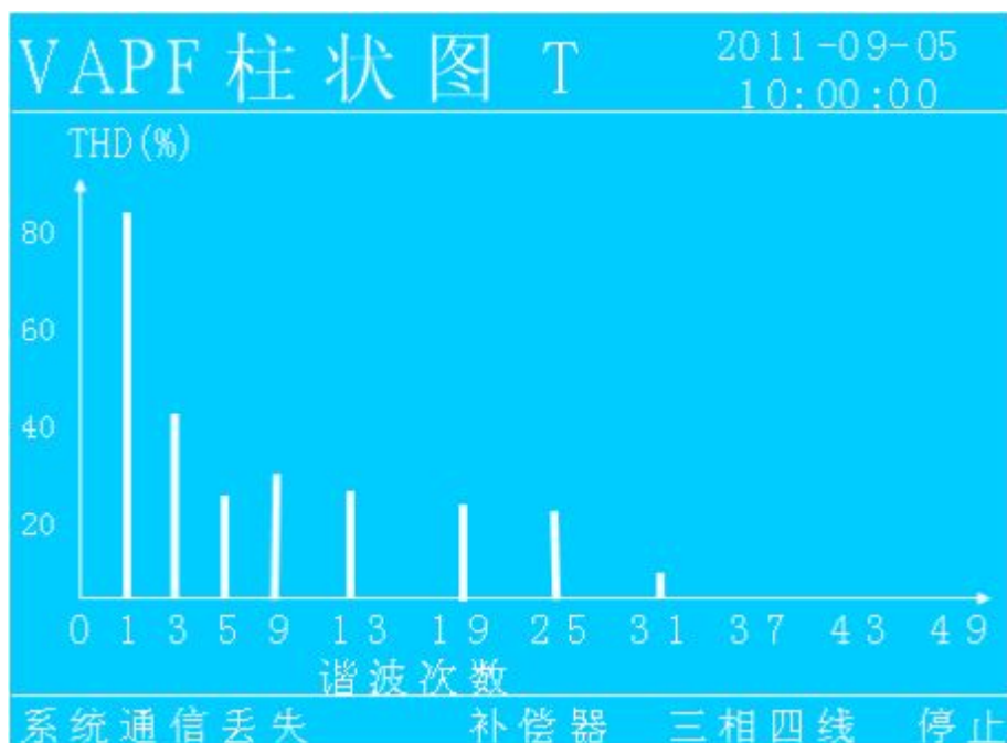
图 5.1.3.5 VAPF 侧 T 相谐波状态图
