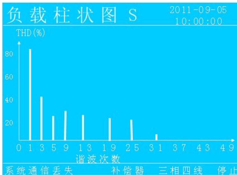
图 5.1.2.4 负载 S 相谐波状态图
