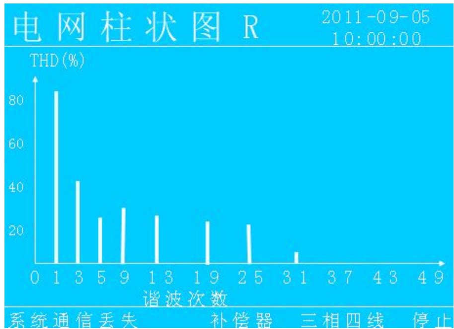
图 5.1.1.3 电网 R 相谐波柱状图
