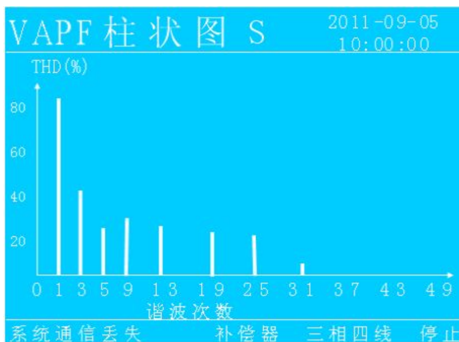
图 5.1.3.4 VAPF 侧 S 相谐波状态图
