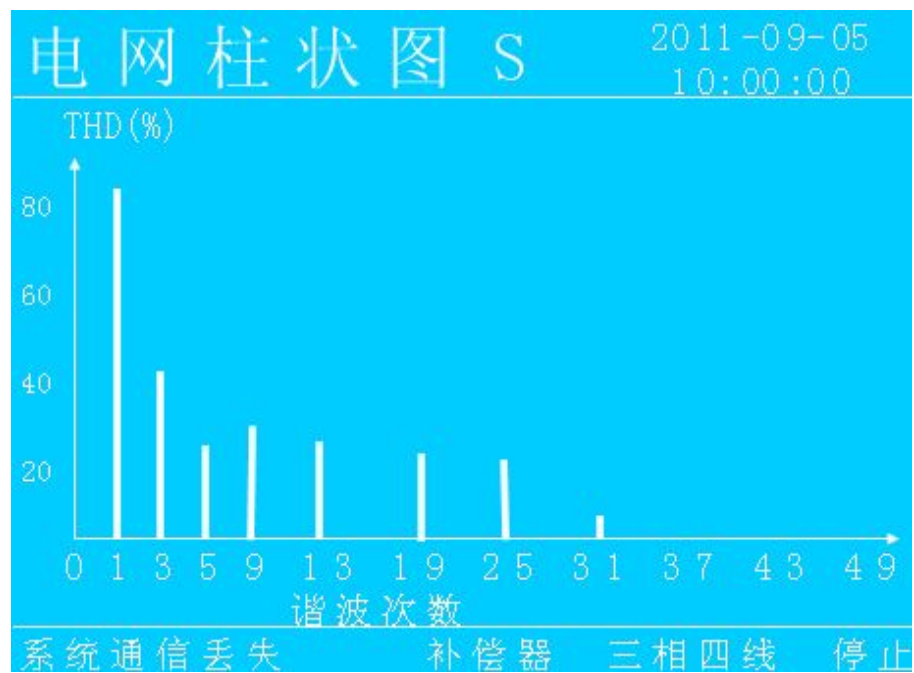
图 5.1.1.4 电网 S 相谐波柱状图
